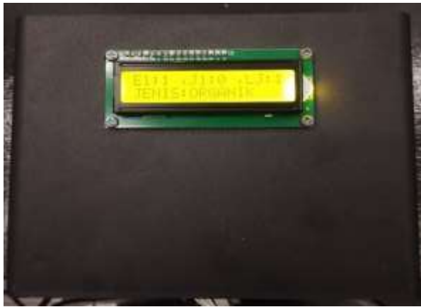
Gambar 10. Hasil Pembacaan Sensor Sistem Smart Tong Sampah Pada Layar LCD
