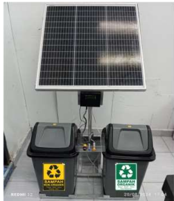
Gambar 9. Hasil Alat Smart Tong Sampah Berbasis IoT dan Panel Surya
