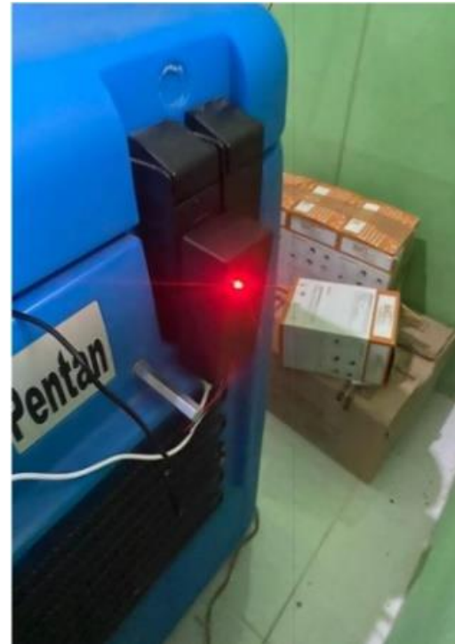
Gambar 19. Penerapan Alat Pemantauan Suhu Cold Chain Box di UPTD Farmasi DINKES Siak
